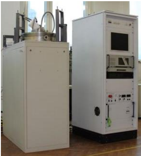
Установка ARDIS-100 для синтеза алмаза в СВЧ плазме. Вид плазмы при синтезе алмазной пленки на подложке кремния диаметром \varnothing 57 мм.
