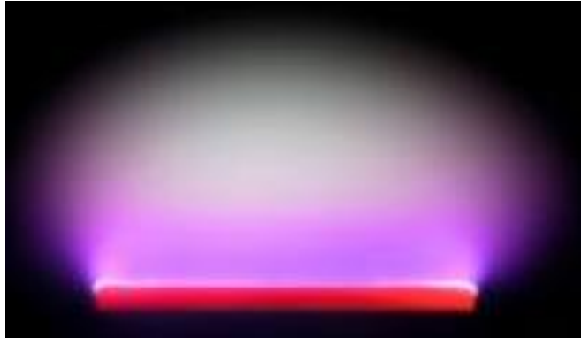
Установка ARDIS-100 для синтеза алмаза в СВЧ плазме. Вид плазмы при синтезе алмазной пленки на подложке кремния диаметром \varnothing 57 мм.
